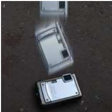
土の上に落下している様子
